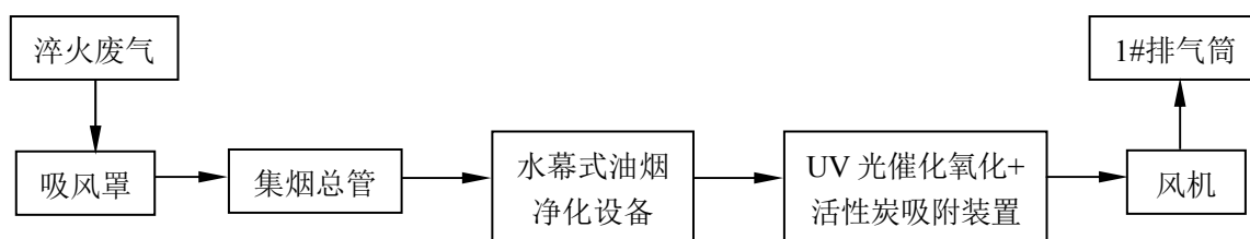
图 8 淬火废气收集处理流程图
